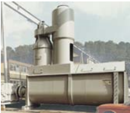
Kalklöschmaschine mit Naßentstauber
